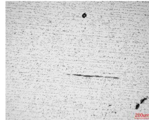
Figuur 5.1: V3 kolom, microstructuur kern
